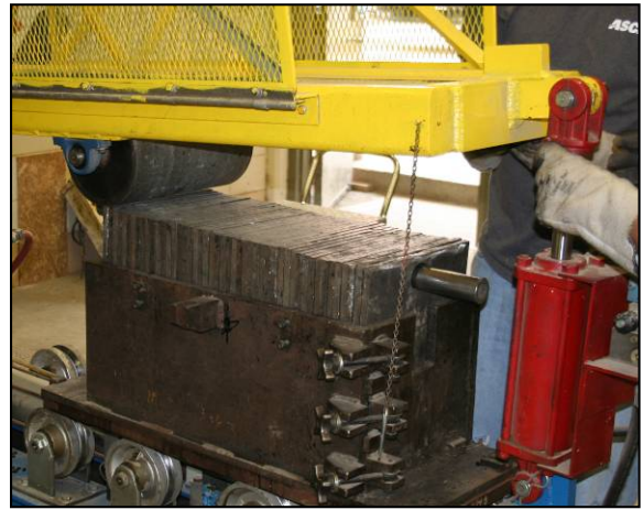
(d) LAC Ready for Compaction
